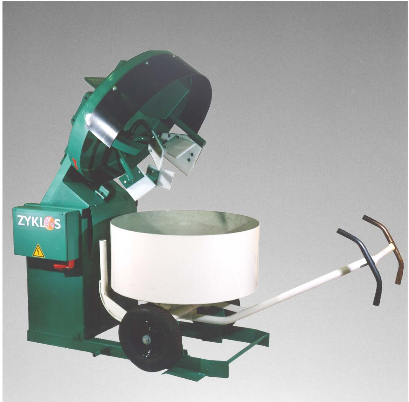
Der ZZ 150 HE kann innerhalb der Baustelle verschoben werden. Dazu muss der Mischer z.B. mit einem Gabelstapler leicht angehoben werden. Die seitlich angebrachten Achsen dienen zur Aufnahme der Räder für den Transport. Die Räder des Simplexwagens werden abgenommen und auf die Achsen gesteckt und gesichert.
